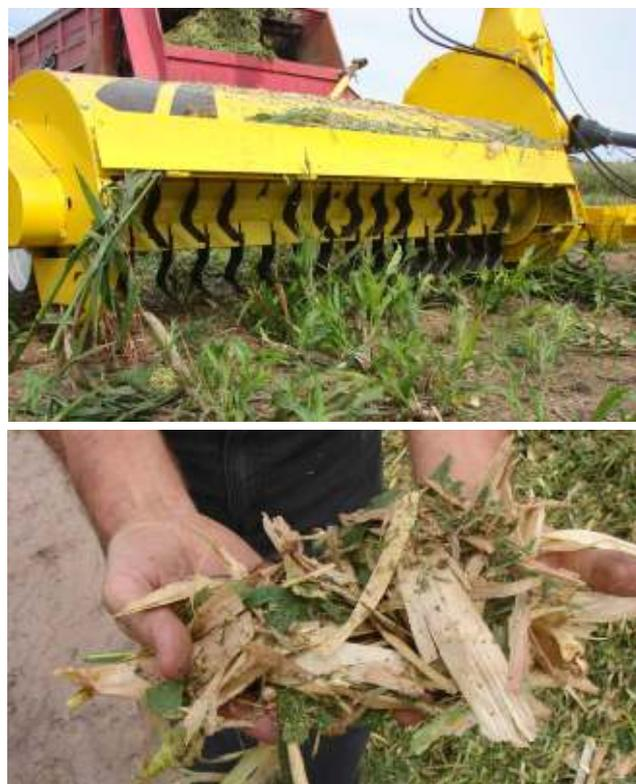
**Figura 2:** Máquina de corte picado directo de forraje con cuchillas largas de corte frontal, con el cual se logra un picado de más de 10 cm, preciso para realizar pastoreo mecánico pero no para alcanzar la calidad de picado necesaria para la confección de silo.
