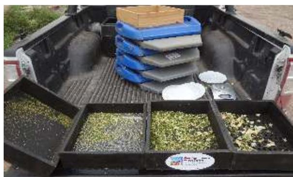
Figura 10: Distribución de partículas según tamaño mediante sistema Penn States
