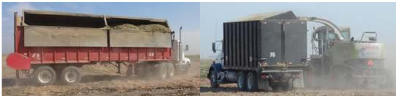
**Figura 13:** sistema de sobretecho en batea de camiones sileros que permiten disminuir las pérdidas al momento de efectuarse el picado.
