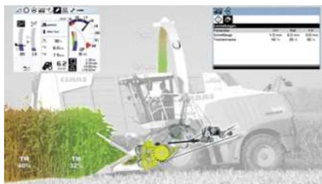
Figura 9: algunos modelos poseen Ajuste automático de la longitud de corte.
