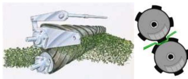
**Figura 1:** Esquema de trabajo de un sistema de acondicionamiento mediante rodillos. (New Holland 2011).
