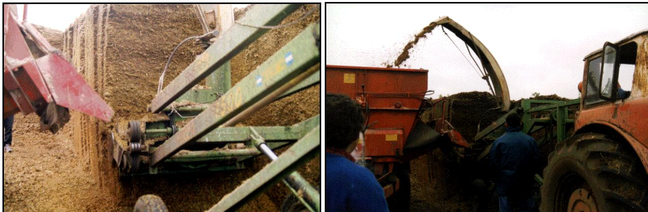
a) Extracción con fresadora de un silo muy bien prensado; el silo no se afloja; se extrae parejo de arriba-abajo;
