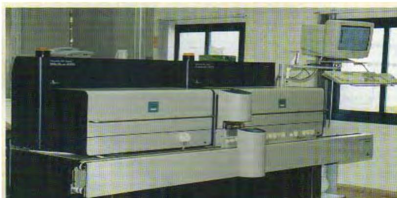
Figura 17. Método fluoro-opto-electrónico (Fossomatic)
