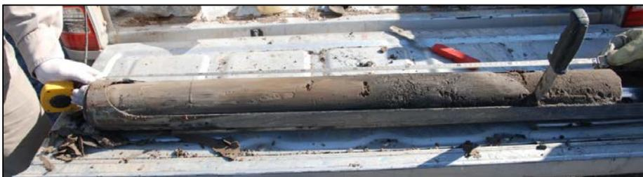
Figura 5. Núcleo de suelo extraído con equipos especiales de muestreo.
