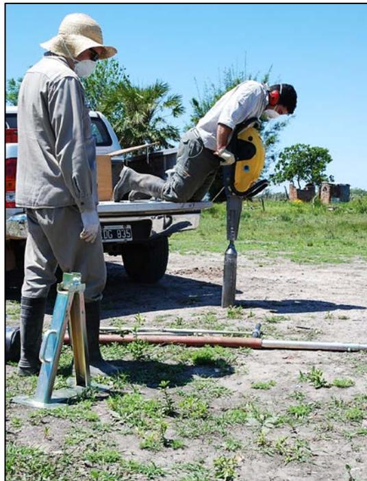
Figura 4. Extracción de las muestras con el muestreador columnar.
