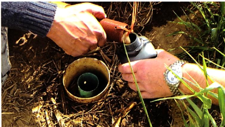
Muestreo de agua de napa para su análisis en un freatímetro instalado al lado del sistema de piletas.
